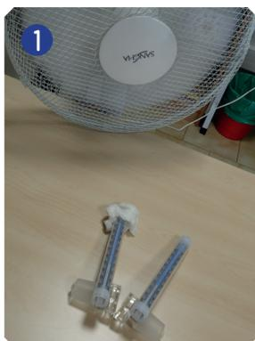
La différence de température entre les deux thermomètres est donc d'autant plus grande que l'air est sec. Au contraire, si l'air est très humide, peu d'eau s'évaporera du coton et la température du thermomètre mouillé diminuera moins.
