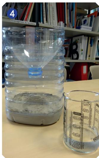
Le pluviomètre est un instrument météorologique destiné à mesurer la quantité de précipitations (surtout la pluie) tombée pendant un intervalle de temps donné en un endroit.
