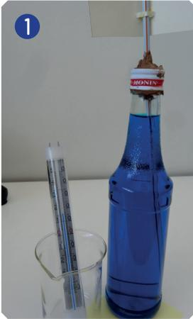
Afin de calibrer ton thermomètre, laisse-le dans une pièce pendant quelques minutes à côté d'un vrai thermomètre (image 1).
