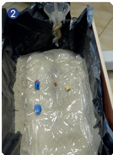
On a simulé l'imperméabilisation des sols (routes, parkings) et le ruissellement (image 2).
