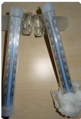
Un courant d'air passe autour des deux thermomètres. (On peut utiliser un petit ventilateur pour avoir une mesure plus précise) (image 1).
